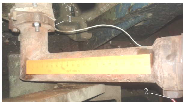
Рис. 2. Места установки термопар (1, 2) в выпускном коллекторе двигателя ВАЗ-311
