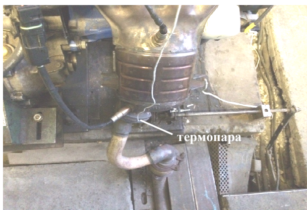
Рис. 1. Место установки термопары в двигателе ВАЗ 11194
